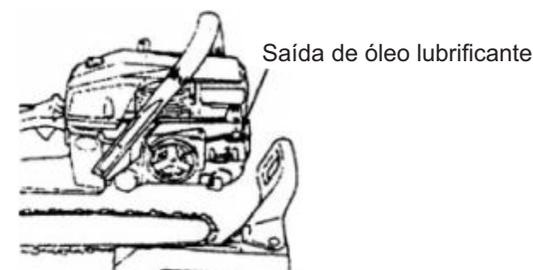
Quando desmontar o sabre, retire toda a serragem ou qualquer sujeira de seus trilhos para manter o canal livre para o fluxo do óleo de lubrificação da corrente, bem como os orifícios de lubrificação, que devem ser limpos com o auxílio de um arame.
