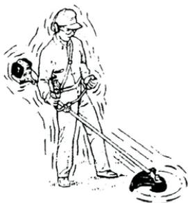
Caso a lâmina prenda na madeira ou capim, não tente livrá-la acelerando o motor ou mexendo o equipamento, uma vez que forçará o equipamento e entortará a lâmina. Caso isto ocorra, desligue o motor e manualmente (com luvas de proteção) solte a lâmina de corte.
