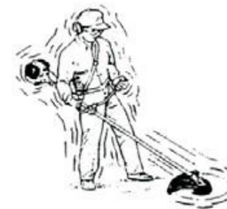
Desligue o motor imediatamente caso ocorra a vibração repentina do equipamento. Sempre desligue o motor quando for transportar o equipamento.
