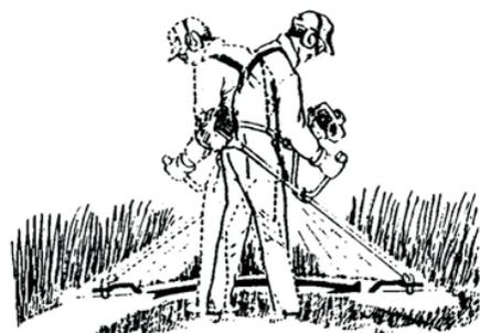
Durante a operação trabalhe com o motor em rotação alta. Se algum arbusto enroscar na lâmina, não acelere para libertá-lo, uma vez que isso danificará a lâmina de corte e a embreagem do equipamento. Para isto, desligue o motor e libere a lâmina com as mãos.
