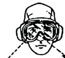
O operador deve usar os óculos de proteção não somente para proteger a vista de qualquer objeto arremessado pela lâmina de corte, como também para evitar inflamação da vista causada pela poeira, pólen e sementes que possam entrar em contato com a vista. Óculos de grau podem ser utilizados por baixo dos óculos de proteção. As pessoas que estiverem dentro da área de perigo, também devem usar os óculos de proteção.
